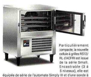
piquer qui permet le refroidissement rapide de 12 kg en 110 mn et la surgélation de 4 kg en 2 heures ! Revêtement intérieur et extérieur inox. Dimensions : L 755 x P 700 x H 965 mm. Hauteur 840 mm avec mini-pieds. Groupe à air logé R452A sans CFC, à faible GPW, conforme à la réglementation F Gaz 2020.
